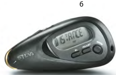
Рис. 162. Курвиметр: а) механический, б) электронный
