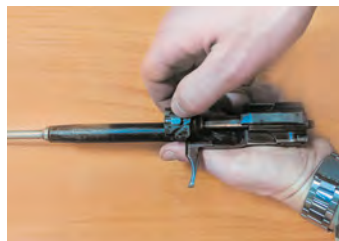
Рис. 134. Отделение затвора от затворной рамы
