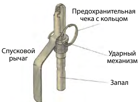
Рис. 140. УЗРГМ (унифицированный запал ручной гранаты модернизированный)
