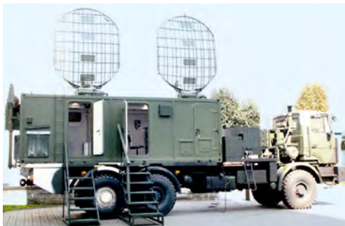
Рис. 63. Радиостанция тропосферной связи Р-432
