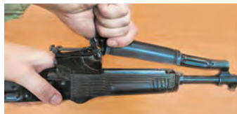
Рис. 135. Отделение газовой трубки со ствольной накладкой
